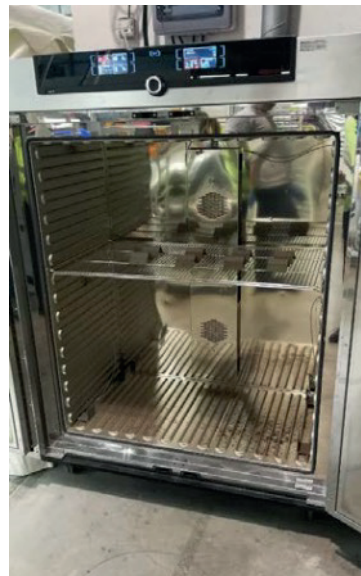
Étuve contrôlée Norme AMS2750 Dimension : H1000 mm x L1200 mm x P500 mm
